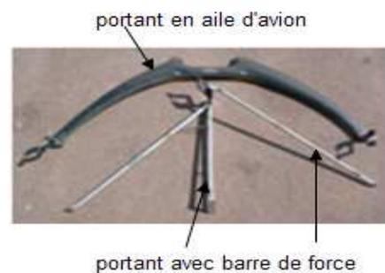
Il est en métal, voire en matériaux composites quand il est en forme d'aile d'avion. Il supporte la dame de nage, mobile autour d'un axe fixe dans laquelle l'aviron se fixe et est maintenu par le tolet ou la barrette.
