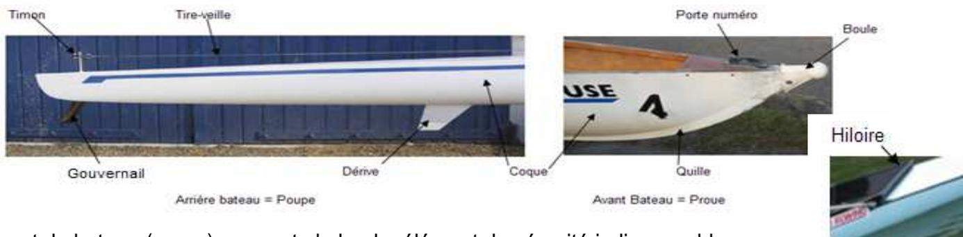
L'avant du bateau (proue) comporte la boule, élément de sécurité indispensable pour naviguer; le porte numéro utilisé lors des régates pour identifier les équipages. L'hiloire empêche l'eau de rentrer dans le bateau en cas de vagues.
